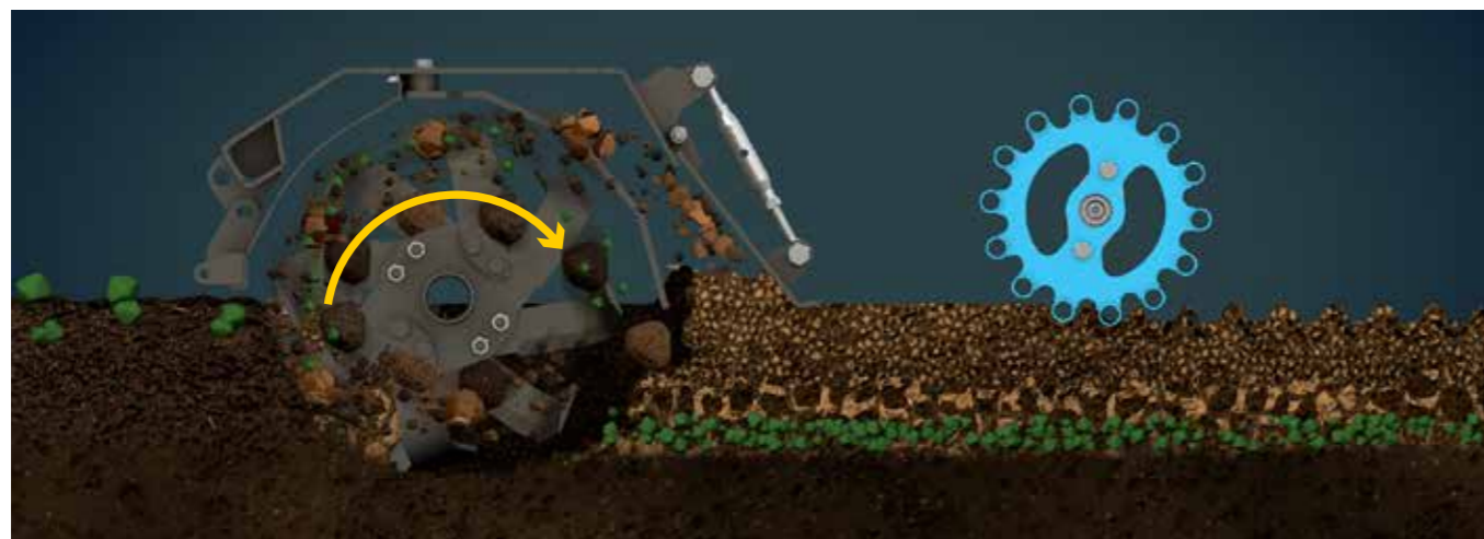
▲ Bewerking van een overtopfrees, de tegen de rijrichting in draaiende freesas. Residu wordt ingefreesd.
