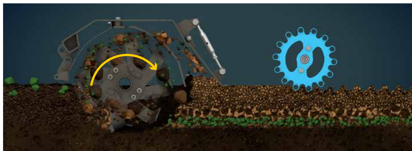
▲ Fonctionnement de la fraise enfouisseur de pierres, l'enfouisseur qui tourne dans le sens inverse de la marche. Les résidus sont broyés.
