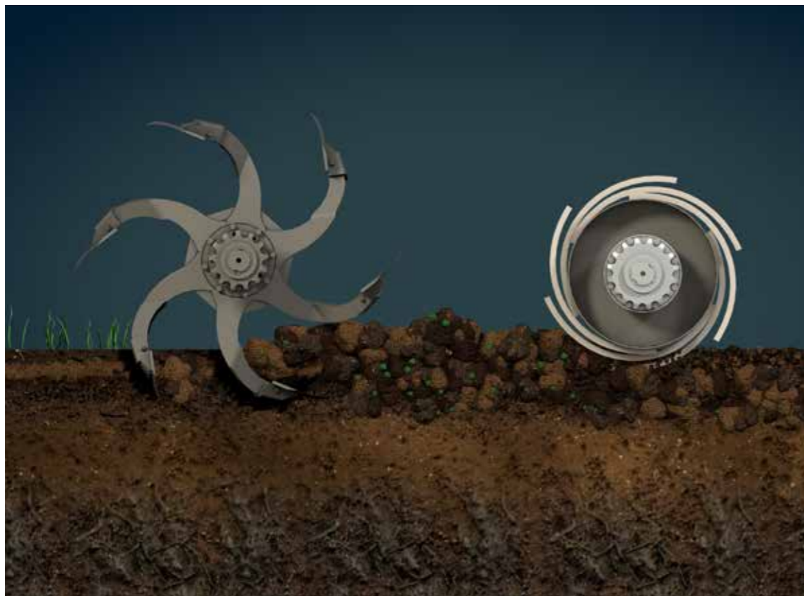
Spatenwelle mit angetriebener Eggenwalze
