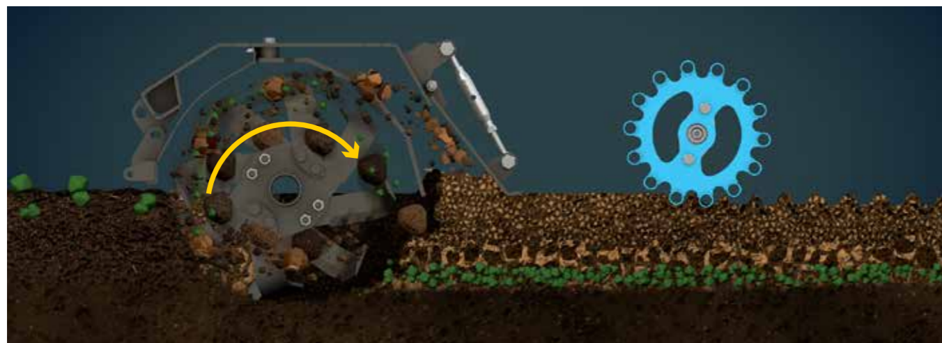
▲ Arbeitsweise der Umkehrfräse, also der Frässtelle, die entgegen der Fahrtrichtung rotiert. Rückstände werden eingefräst.
