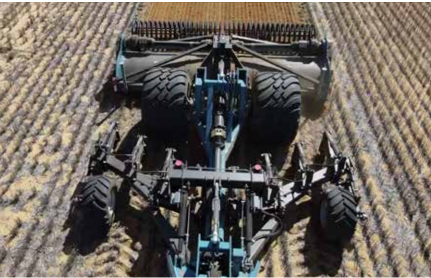
▲ Systemträger mit einem 450 cm breiten, starren Tiefenlockerbalken. Abgebildet mit 58SX Spatenmaschine mit Dachringwalze.
