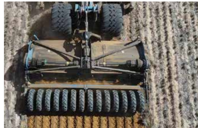
▲ Systemträger mit einem 450 cm breiten, starren Tiefenlockerungsbalken. Abgebildet mit 58SX Spatenmaschine mit Reifenrückverdichtungswalze.
