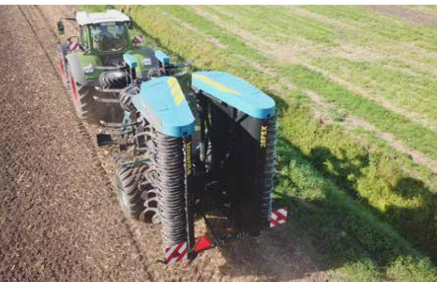
▲ Systemträger mit klappbarem Tiefenlockerbalken und Spatenmaschine mit 600 cm Arbeitsbreite. Abgebildet mit Spatenmaschine 38FSX, zusammengeklappt in Transportstellung 300 cm breit.
