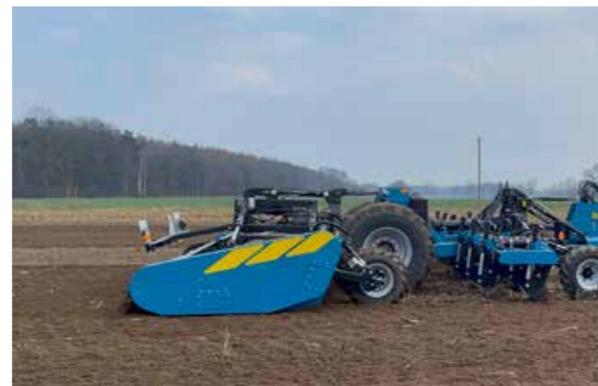
▲ Systemträger mit klappbarem Tiefenlockerungsbalken von 600 cm Breite. Abgebildet mit Spatenmaschine 38FSX, Transportbreite (hochgeklappt) 300 cm.
